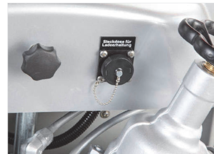
■ BEOS ELEKTRICKÁ ZÁSUVKA obj.č. 1146206 Tří-pólová šroubovací zásuvka, pro udržování napájení UP4 pomocí sady BEOS.
