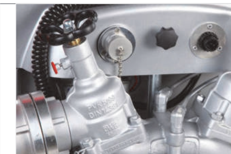
■ ZÁSUVKA FIRECAN obj.č.1118987 Rozhraní mezi UP4 a externími komponenty podporujícími tento systém. Lze jej použít místo systému BEOS a MagCode
