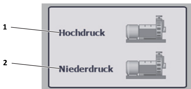
Obrázek 19: Část obrazovky s údaji o čerpadlech vody pro zkoušky hadic
